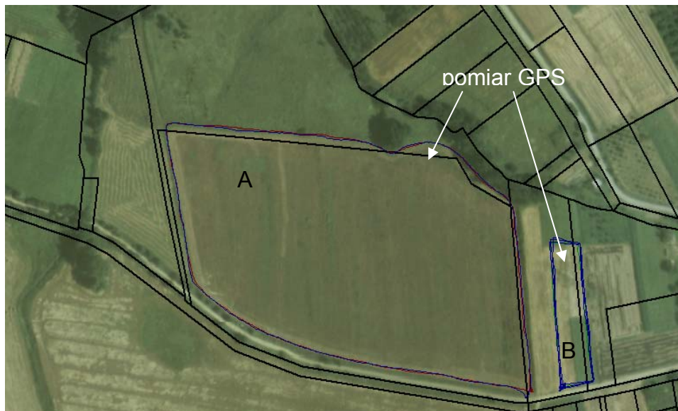
Rys. 49. Przebieg granic działek rolnych (A, B) z pomiaru bezpośredniego GPS, działek ewidencyjnych (kolor czarny) na tle ortofotomapy
